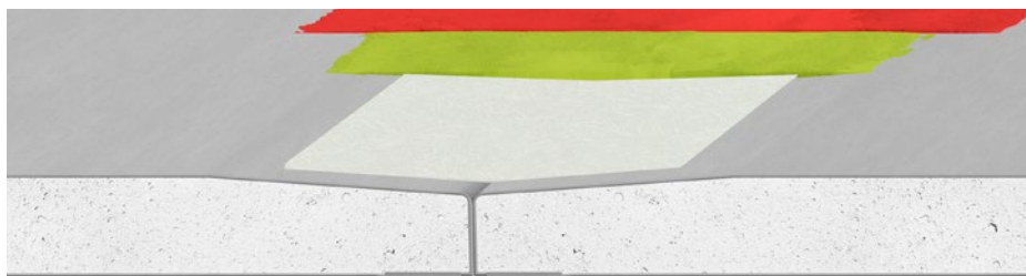
Rys. 2. Spoinowanie krawędzi typu NS z użyciem taśmy samoprzylepnej.
