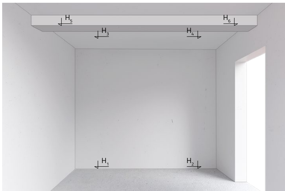
Rys. 13. Sposób prowadzenia pomiarów odchylenia od kierunku poziomego.
