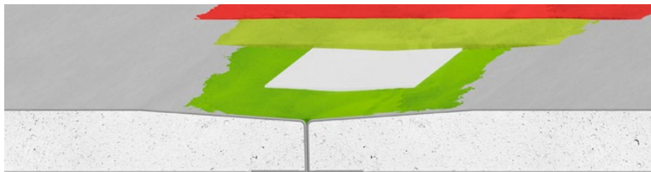
Rys. 4. Spoinowanie krawędzi typu NS z użyciem taśmy fizeleinowej lub taśmy papierowej.
